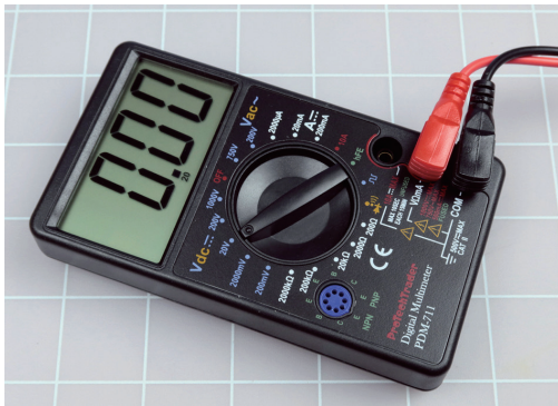
그림 1-1 기본 기능만 갖춘 디지털 계측기. 바탕의 정사각형은 한 변이 1인치(2.5cm)이다.
